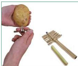
*Un ensemble de 6 carottiers pour réaliser des échantillons de frites de taille régulières destinés aux tests de friture. Les carottiers ont un diamètre de 4 à 10,5 mm. Dotés d'une pointe pour pousser l'échantillon. Tailles en mm : 4 ; 5 ; 6,5 ; 7,8 ; 9 ; 10,5*
