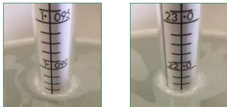
La teneur en matière sèche (à droite) et le poids spécifique (densité) (à gauche) sont lus directement sur la tige graduée au niveau de la ligne de flottaison.
