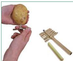
*Un ensemble de 6 carottiers pour réaliser des échantillons de frites de taille régulières destinés aux tests de friture. Les carottiers ont un diamètre de 4 à 10,5 mm. Dotés d'une pointe pour pousser l'échantillon. Tailles en mm : 4 ; 5 ; 6,5 ; 7,8 ; 9 ; 10,5*
