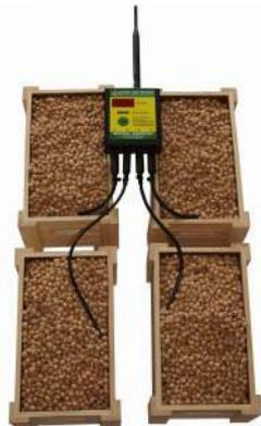
Kabellose Funksender werden an flexiblen Erntegut-Sensoren in Kisten oder lose gelagerten Kartoffeln angebracht. Temperaturdaten werden per SIM-Karte ins Internet übertragen und können von jedem Ort aus abgerufen werden.
