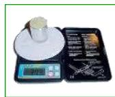
Das Kit funktioniert, indem ein Kern aus einer vorgeschneittenen Knolle entnommen, sehr genau gewogen und das Gewicht mithilfe einer Kalibrierungstabelle in Prozent Trockenmasse umgerechnet wird.
