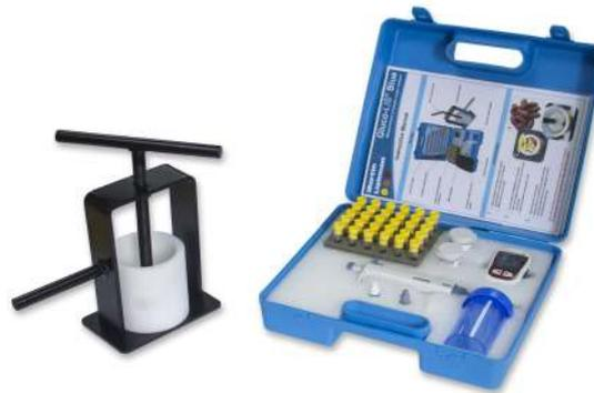
*Glucolis Blue testet den Glukosegehalt von Saft, der aus einer Kartoffelprobe extrahiert wurde, mit der gleichen Technologie, die von Diabetikern verwendet wird, jedoch kalibriert für Kartoffelzucker.*
