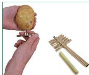
*Ein Satz von 6 Ausstechern zur Herstellung von Pommes-Frites-Proben einheitlicher Größe für die Verwendung bei Pommes-Frites-Tests. Die Fräser haben einen Durchmesser von 4 bis 10,5 mm. Enthält einen Spike, um die Probe herauszuschieben. Größen in mm: 4, 5, 6.5, 7.8, 9, 10.5*
