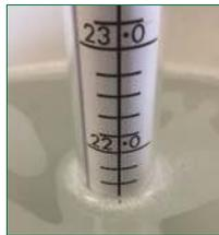
Der Punkt, an dem die Wasseroberfläche die vertikale Skala kreuzt, ist der Messwert für die Trockenmasse (rechts) und das spezifische Gewicht (links).
