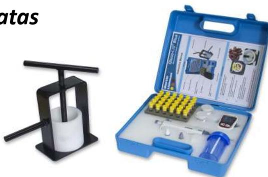
*Glucolis Blue evalúa el contenido de glucosa del zumo que se extrae de una muestra de patata utilizando la misma tecnología que utilizan los diabéticos, pero calibrada para el azúcar de la patata.*
