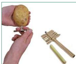
Un conjunto de 6 cortadores para cortar patatas francesas de tamaño constante para usar en pruebas de frituras. Los cortadores tienen de 4 a 10,5 mm de diámetro. Incluye una púa para extraer la muestra. Tamaños en mm: 4; 5; 6,5; 7,8; 9; 10,5
