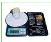
*El kit trabaja tomando el centro de un tubérculo previamente cortado, lo pesa de manera muy exacta y convierte el peso a un promedio de materia seca utilizando una tabla de calibración.*
