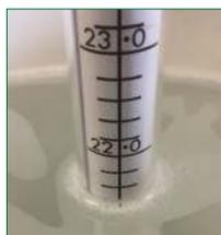
*El punto en el que la superficie de agua pasa la escala vertical es la materia seca (derecha) y la lectura de la gravedad específica (izquierda).*
