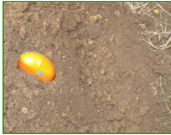
TuberLog kann mit Kartoffeln vom Feld geerntet werden
