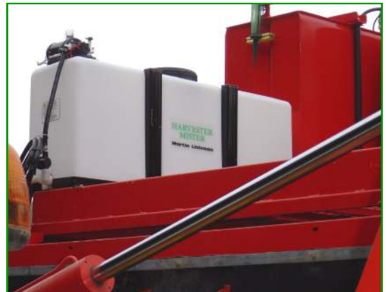
Die 125-Liter-Anlage Harvester Mister auf einem Grimme Kartoffelroder
