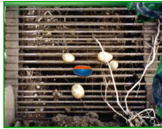
TuberLog kann komplette Kartoffelroder testen
