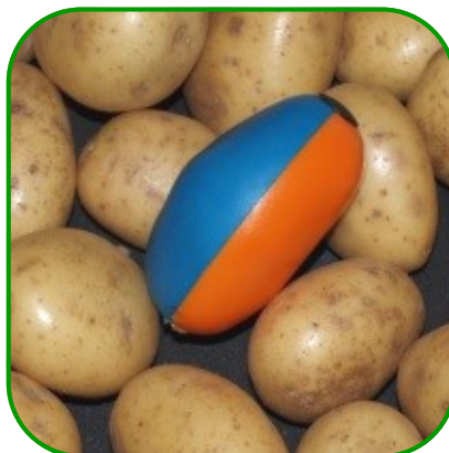
TuberLog Elektronischer Kartoffel-Dummy
