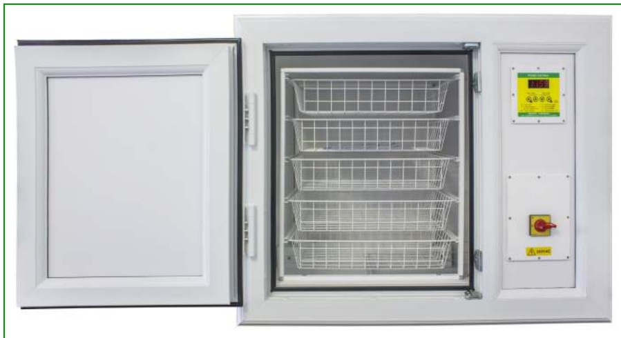
Standaard Aardappel Hot Box – capaciteit 125 knollen met 5 lademanden
