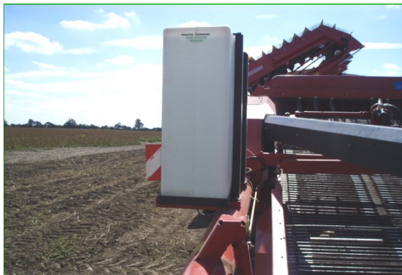
De 250 liter Oogst Vernevelaar gemonteerd op een aardappelrooier
