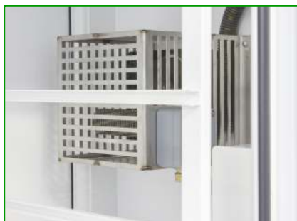
Binnenzijde van de Hot Box voor 750 knollen, zichtbaar de ventilator en verwarming met bevochtigingsysteem
