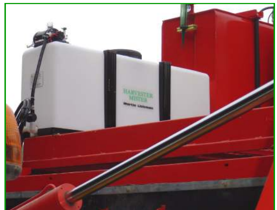
De 125 liter Oogst Vernevelaar gemonteerd op een Grimme aardappelrooier
