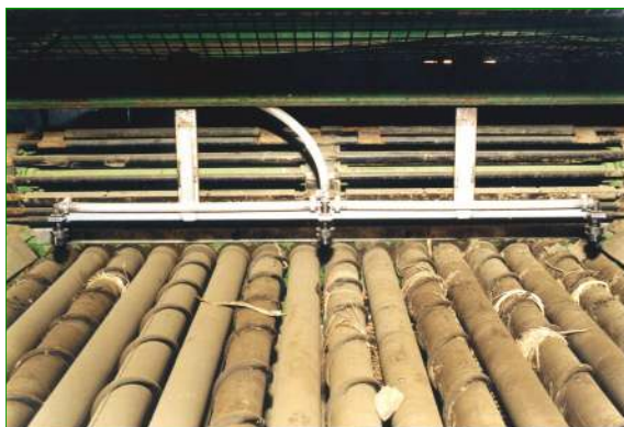
Oogst Vernevelaar 1 meter sproeiboom gepositioneerd boven rollers
