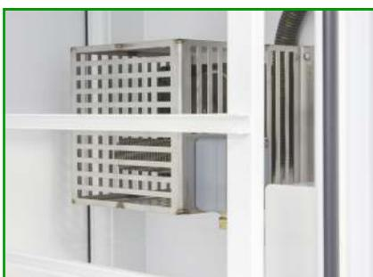
Intérieur d'une Hot Box pour 750 tubercules avec ventilateur et réchauffeur, et système d'humidification à doubles mèches
