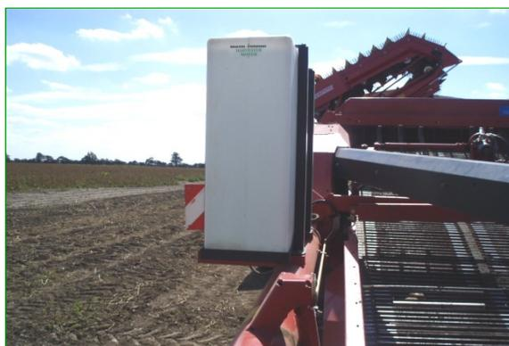
Le nébulisateur *Harvester Mister* de 250 litres monté sur une arracheuse de pommes de terre
