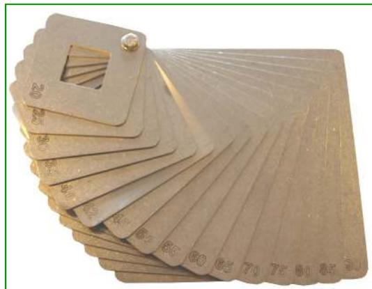
Jeu de carrés de dimensionnement de pomme de terre de taille 20 à 90 mm par intervalles de 5mm, 16 dimensions, incluant la taille 42mm.
