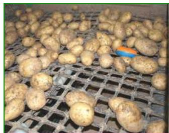
TubercLog peut traverser la chaîne de triage
