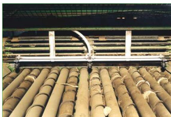
Rampe de pulvérisation de 1 mètre du nébulisateur *Harvester Mister* positionné au-dessus des rouleaux transversaux Dolman
