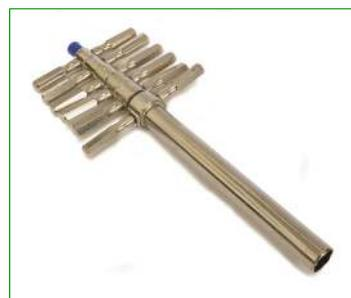
Un jeu de coupe-frites permettant de produire des frites de tailles identiques à utiliser dans le cadre de procédures de contrôle.
