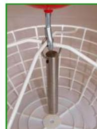
Calibrage aisé à l'aide du poids étalon fourni
