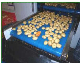
TubercLog peut contrôler la chute des convoyeurs aux trémies
