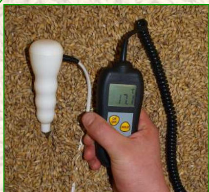
Surveillance de température
