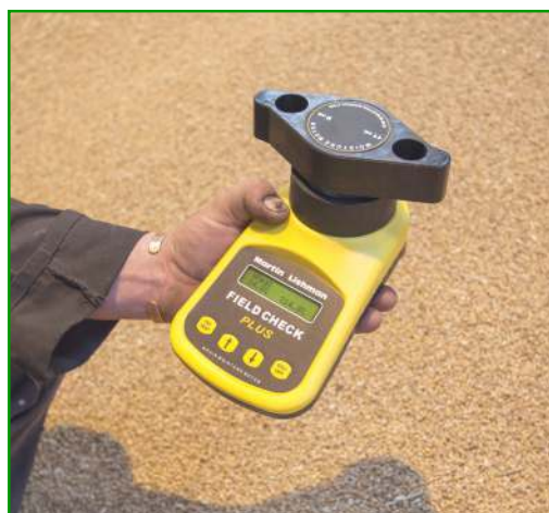
Field Check est idéal pour vérifier les bennes avant leur déversement sans le silo
