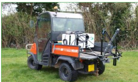
Pulvérisateur Mini Spray démontable - le réservoir de 125 litres s'installe parfaitement sur le plancher de l'utilitaire Kubota RTV
