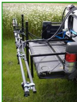
Détail de la rampe démontable
