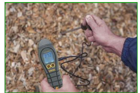
Feuchtigkeitsmessung von Holzhackschnitzeln - Timbermaster mit 600mm langer Sonde
