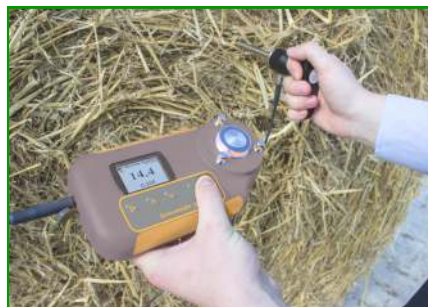
Feuchtigkeitsmessungen in Ballen mit der 600mm Ballen-Messsonde des Grainmaster i2-s
