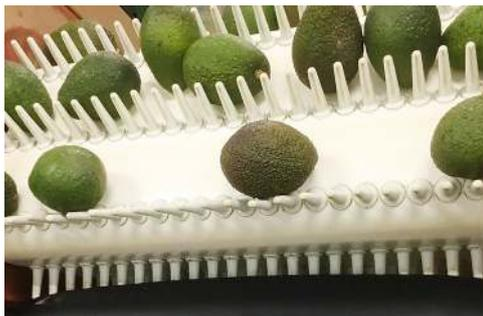
L'utilisation du dispositif ImpacTrack a permis aux entreprises de traitement des avocats d'apporter des modifications aux machines de calibrage et de conditionnement et d'éliminer les pertes importantes liées à l'endommagement des fruits
