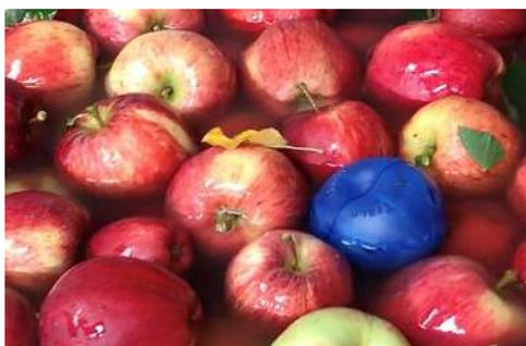
Grâce au dispositif ImpacTrack, les entreprises de traitement des pommes ont amélioré les systèmes de la chaîne de production et ont rapidement pris des mesures correctives pour éviter l'endommagement de ces fruits
