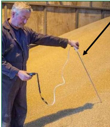
Reaktionsschneller, 1,5 m langer Edelstahlsensor – es können mehrere Messungen in kurzen zeitlichen Abständen vorgenommen werden
