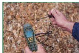
Para medir de manera rápida y simple la humedad de la astilla de madera. Cuenta con una fuerte sonda de humedad de 600 mm para soportar un uso intensivo.
