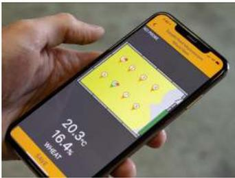
Laden Sie Feuchte- und Temperaturmesswerte sofort mit der Grainmaster App herunter. Die Messwerte des Messgeräts oder einer der optionalen Sonden können sofort über Bluetooth an ein Smartphone gesendet werden, was den Aufzeichnungsprozess beschleunigt und die Vorlage von Nachweisen für Erntegut-Sicherungsprogramme erleichtert.
