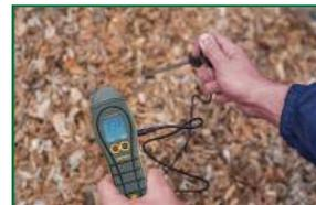
Zur schnellen und einfachen Messung der Hackschnitzelfeuchte. Wird mit einer robusten 600-mm-Feuchtigkeitssonde geliefert, die auch starker Beanspruchung standhält.
