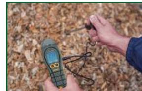
Para medir de manera rápida y simple la humedad de la astilla de madera. Cuenta con una fuerte sonda de humedad de 600 mm para soportar un uso intensivo.
