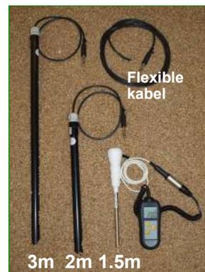
Mobile und fest installierte Messfühler zum Anschluss an das Temperatur-Display Minitemp. Der schnell ansprechende 1,5-m-Temperaturfühler ist aus Edelstahl; die fest installierten Messlanzen sind aus starrem PVC (Länge 2 m oder 3 m) oder flexible Kabel beliebiger Länge.
