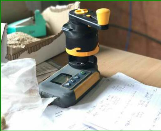
Der Protimeter *Grainmaster i-S* ist das am häufigsten betriebsintern genutzte tragbare Feuchtigkeitsmessgerät in Großbritannien. Da es ein Feuchtigkeitsmessgerät mit Mahlwerk ist, können Sie darauf vertrauen, dass die Feuchtigkeitsmesswerte korrekt sind. Erhältlich mit einer Reihe von Sonden.
