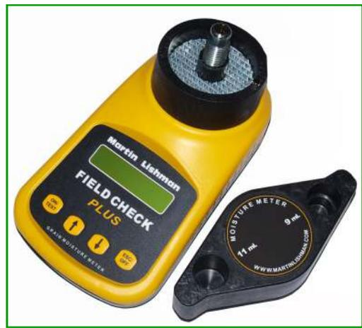
Field Check<sup>PLUS</sup> ist ein Messgerät für gemahlene Getreide mit zwei verschiedenen in den oberen Bereich des Mahlwerks eingelassenen Messbechern.
