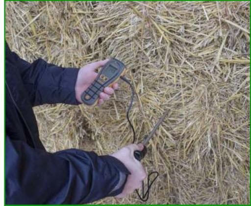
Der Protimeter *Balemaster* zeigt die Feuchtigkeit von Heu- und Strohballen sofort an. Er wird eingesetzt, um zu ermitteln, ob Ballen einlagerungsfähig sind. Erhältlich mit einer 600mm langen Ballen-Sonde.
