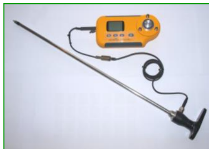
Feuchtigkeitsmessungen in Ballen mit der 600mm Ballen-Messsonde des Grainmaster i-S
