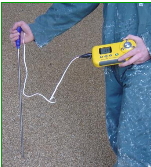
Messung der Getreidetemperatur mit der 1,5m langen Messsonde des Protimeters
