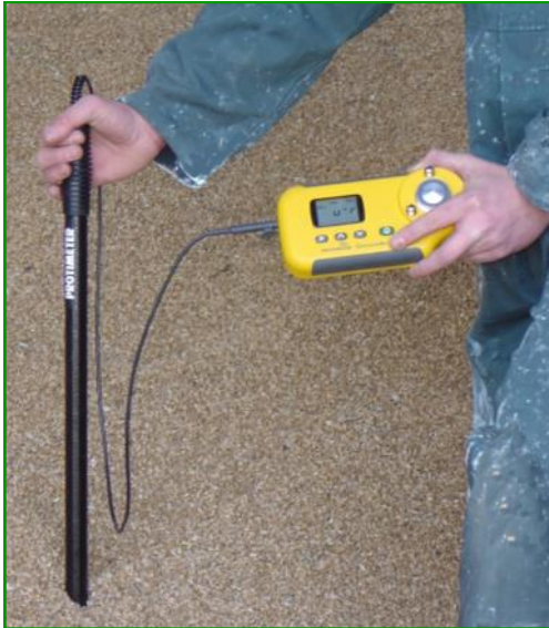
Messungen im Ernteguthaufen mit der 1,5m langen Feuchtigkeits- und Temperatursonde des Protimeters
